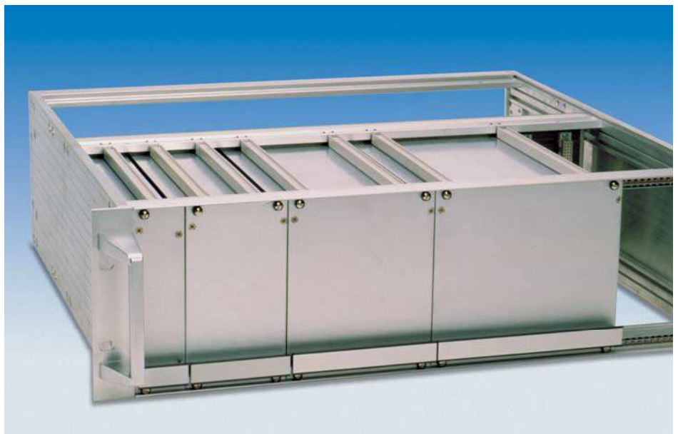
HF-Kassetten unterschiedlicher Breite in einem 19"-Baugruppenträger
